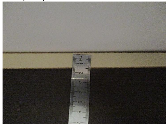
Вздутие шпона в верхней части шкафа.
